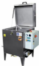
Beheizbar für wässrige Reinigungsmittel. Zur Entfernung von Öl- und Fettverschmutzungen in kürzester Zeit. Universell einsetzbar für die vollautomatische Reinigung von Kleinteilen aus Produktion, Fertigung, Instandhaltung, wie z. B. Bolzen, Hülsen, Kugellagern.
